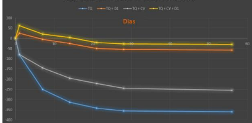
EXPANSIÓN CONTRASTADA SEGÚN UNI 8148 Met B
