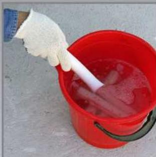
2. Usando los elementos de seguridad requeridos, proceda a colocar en un recipiente plástico, agua limpia y fría (inferior a 25 °C), hasta medio llenarlo.
